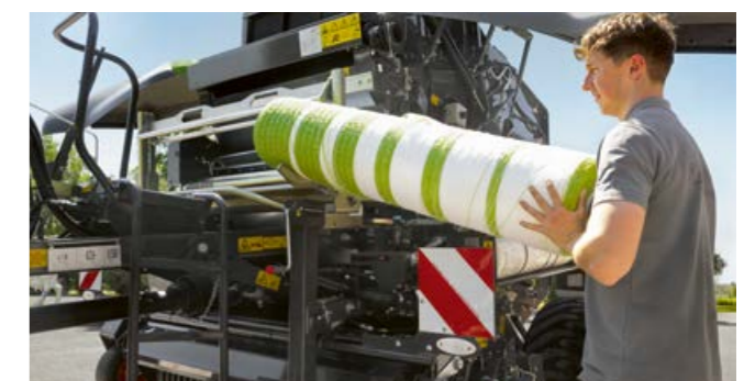
VARIANT 500 sarja uus võrksidumissüsteem paikneb 25 cm madalamal, et saaksite võrgupiduri all olevat võrgurulli hõlpsasti puhastada.
