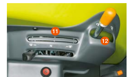
Jõuvõtuvõlli lülitamise hüdrauliline tugi kuulub standardvarustusse. REVERSHIFTiga masina puhul on elektrooniline jõuvõtuvõlli lülitamine saadaval lisavarustusena.
