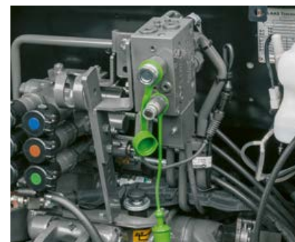
Hüdrauliline kahe ahelaga haagisepidur võimaldab Teil olla ka transporditöödel paindlik.
