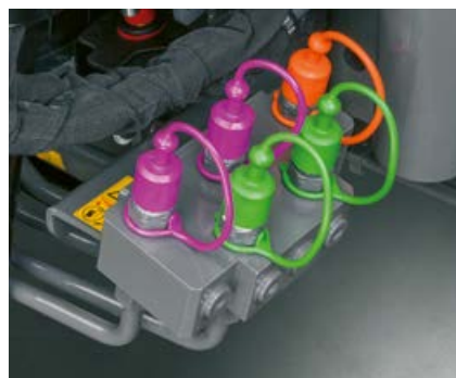
Kabiini ees paremal on saadaval kuni neli hüdroühendust ja vaba tagasivool.
