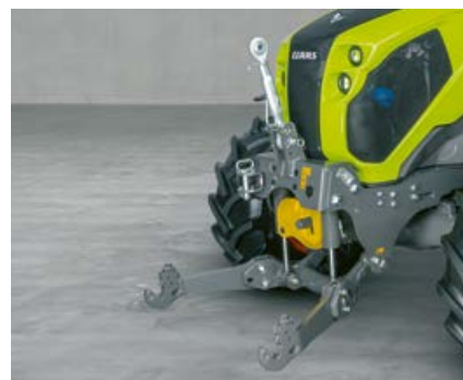
Lisavarustusse kuuluv 3,2 t tõstejõuga esirippsüsteem ja eesmine jõuvõtuvõll laiendavad ELIOSe rakendusvõimalusi.
