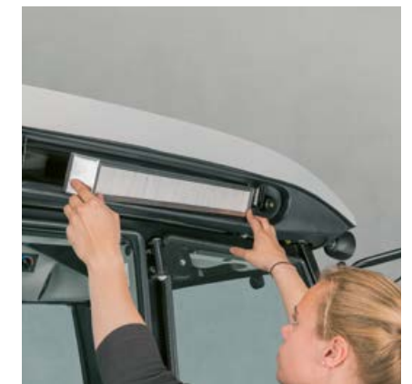
Kabiiniõhu filter, mida pääsete väljast lihtsalt puhastama, hoiab kabiinis õhu alati värskena.
