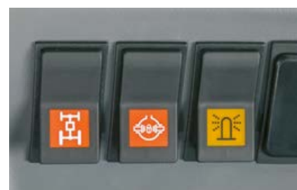
Nelikveo ja diferentsiaaliluku elektriline lülitamine: kiirusest olenev ohutuskatkesti väldib kasutusvigu.
