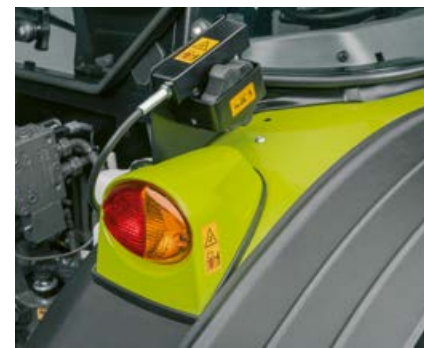
Haakeriista kinnitamisel saab mehaanilist tagarippsüsteemi väljas juhtida traktori tagaosast.
