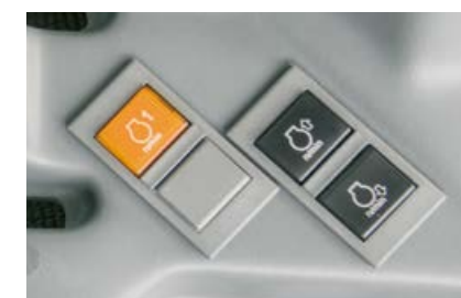
Jõuvõtuvõlli töö on ELIOSe puhul väga lihtne, kuna mootori pöörlemiskiiruse salvesti kuulub standardvarustusse.
