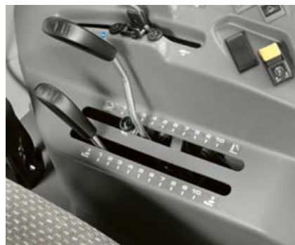
Mehaanilise tagarippsüsteemi reguleerimise juhtseadised on paigutatud ergonoomiliselt juhiistmest paremale.
